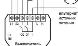
Рис.1 Электрическая схема для подключения Выключателя с Двумя Реле
